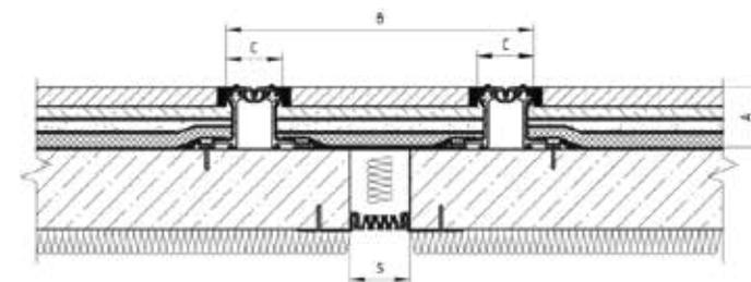
Где A= 60 и 100мм, S=50-500мм, C=95,111 и 115мм
