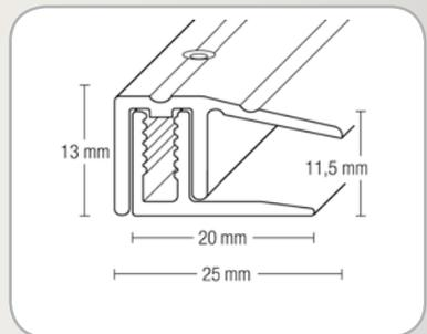
PLP 7/17 Schraubensystem • Set inkl. Basisprofil • für 7-17 mm Bodenbelagsstärke
