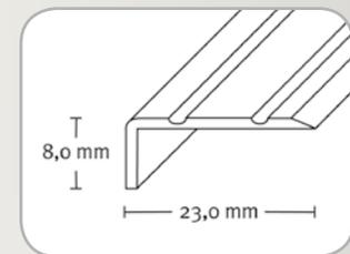
Aluminium, hart, fundesign®-Beschichtung in Holzoptik, Abschluss selbstklebend
