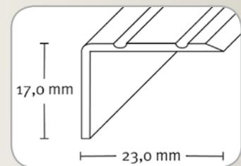
Aluminium, hart, fundesign®-Beschichtung in Holzoptik, Abschluss, selbstklebend
