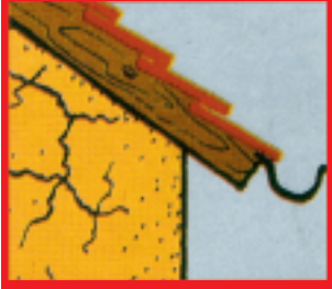
Kılcal ağ tarzında çatlaklar
