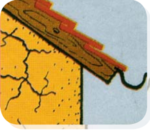
Kılcal Ağ Tarzında Çatlaklar
